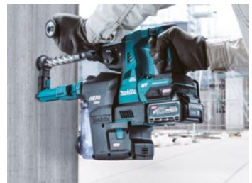
Πιστολέτο με σύστημα αναρρόφησης της σκόνης
